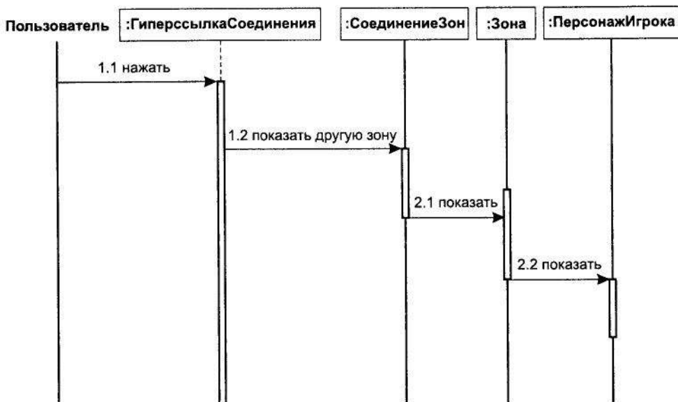
Рис. 4.25. Диаграмма последовательности для варианта использования «Перейти в соседнюю зону»
