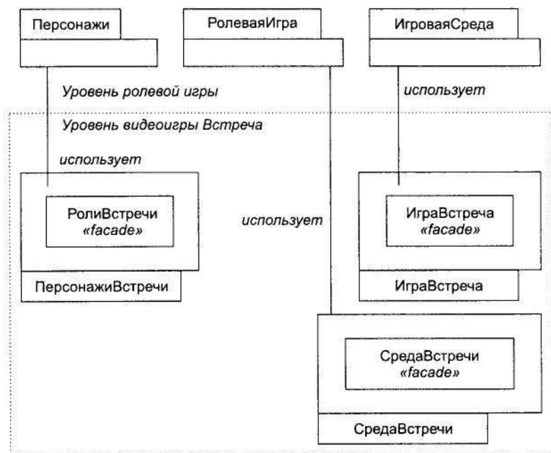
Рис. 5.41. Зависимости между пакетами приложения и каркаса
