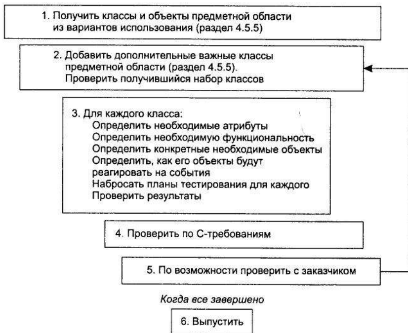
Рис. 4.12. Схема D-требований с использованием объектно-ориентированного стиля
