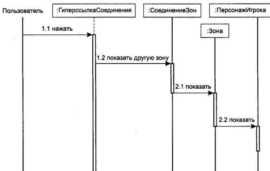
Рис. 4.13. Диаграмма последовательности для варианта использования «Перейти в соседнюю зону»
