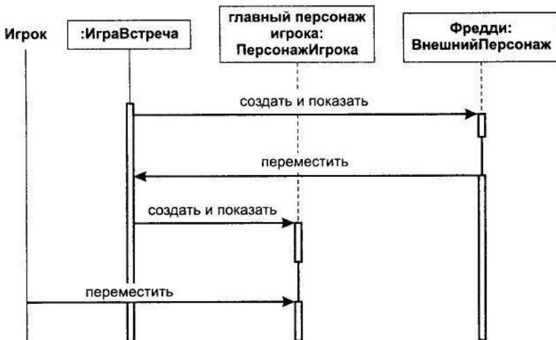
Рис. 4.9. Диаграмма последовательности, показывающая параллелизм
