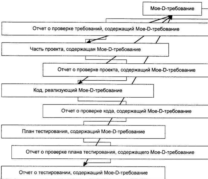
Рис. 4.4. Контроль D-требования (стрелки показывают основные линии прослеживания)
