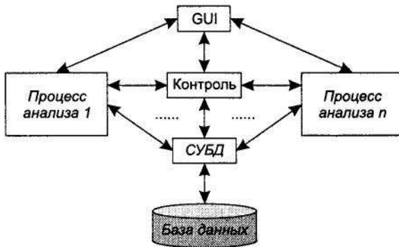
Рис. 5.28. Типичная репозиторная архитектура
