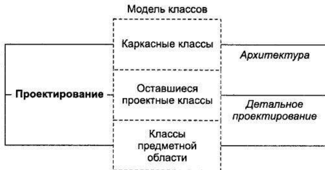
Рис. 5.12. Сравнение модели классов с архитектурой и детальным проектированием
