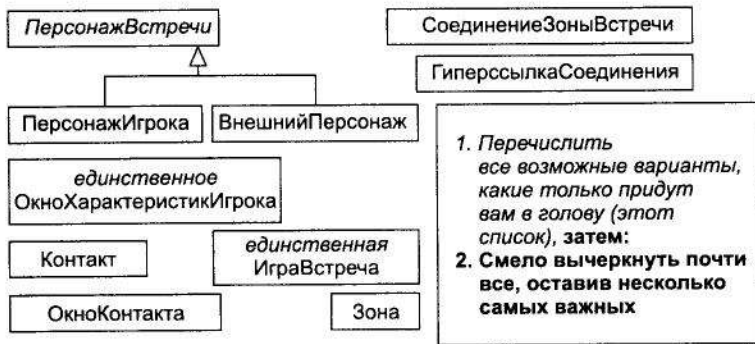
Рис. 4.16. Классы для видеоигры Встреча с отмеченным наследованием
