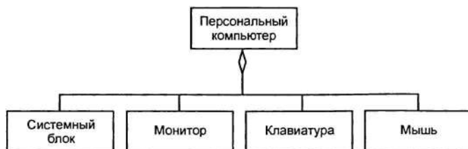
Рис. 4.17. Диаграмма классов для иллюстрации отношения агрегации на примере структуры персонального компьютера
