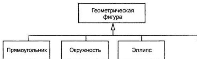
Рис. 4.21. Пример графического изображения обобщения классов
