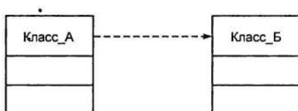
Рис. 4.12. Графическое изображение отношения зависимости на диаграмме классов
