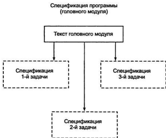
Рис. 3.12. Первый шаг формирования модульной структуры программы при конструктивном подходе
