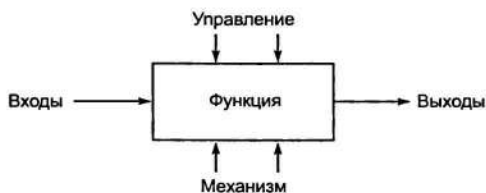
Рис. 3.22. Функциональный блок и интерфейсные дуги
