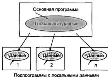
Рис. 1.3. Архитектура программы, использующей подпрограммы с локальными данными
