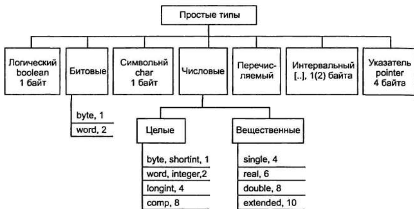
Рис. 3.2. Структура простых типов PASCAL
