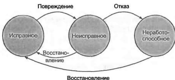
Рис. 5.3. Диаграмма состояний и переходов при отказе
