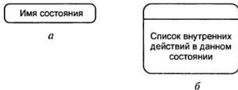
Рис. 3.50. Графическое изображение состояний на диаграмме состояний
