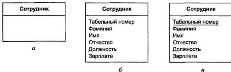
Рис. 3.31. Обозначения сущности в нотации Баркера:
